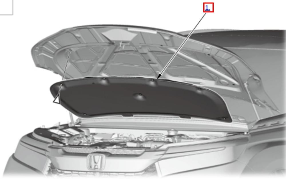
1. 发动机盖隔音板-拆卸
