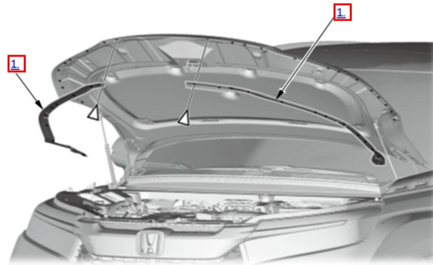
1. 发动机盖密封件-拆卸
